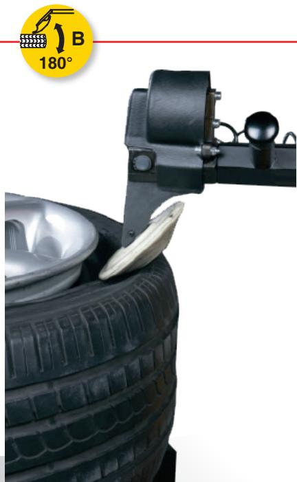
**IT** Stallonatore pneumatico monobraccio a disco telescopico. Questo sistema di stallonatura, composto da un unico braccio, prevede l'utilizzo di un apposito disco ribaltabile a 180° attraverso il quale è possibile stallonare entrambi i fianchi del pneumatico. Con questo sistema, la stallonatura avviene in modo rapido, preciso e sicuro anche sulle ruote più impegnative e dure.
