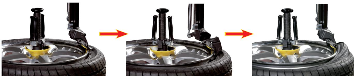
**IT** Gruppo di smontaggio e montaggio dove l'utensile è posizionato su un braccio mobile ad apertura laterale. Le operazioni sono garantite senza l'utilizzo della leva.
